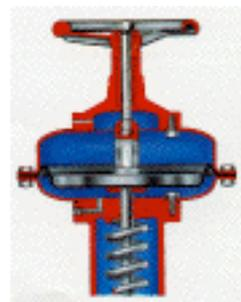
Figure 16 – Servo moteur à action inverse
