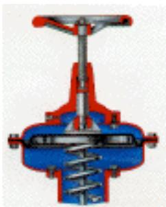
Figure 15 – Servo moteur à action directe
